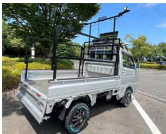
荷崩れ防止・落下防止を目的とした荷台側面設置の上下伸縮する特殊フレーム
