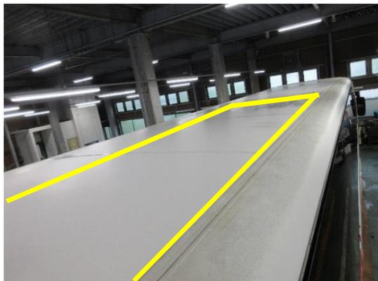
SPACECOOL®施工完成（黄色線の内側へ施工）
