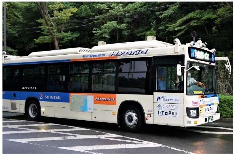
「遠隔監視・操作システム」で走行中の自動運転バス
