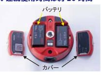
Li-ion バッテリ (BP09) を2個 搭載。ホットスワップ対応で観測 中でも交換が可能です。
