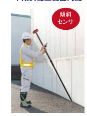
ポールの傾斜が ±60° 以内であれば、傾斜セ ンサにより、リアルタイ ムに座標を補正します。
